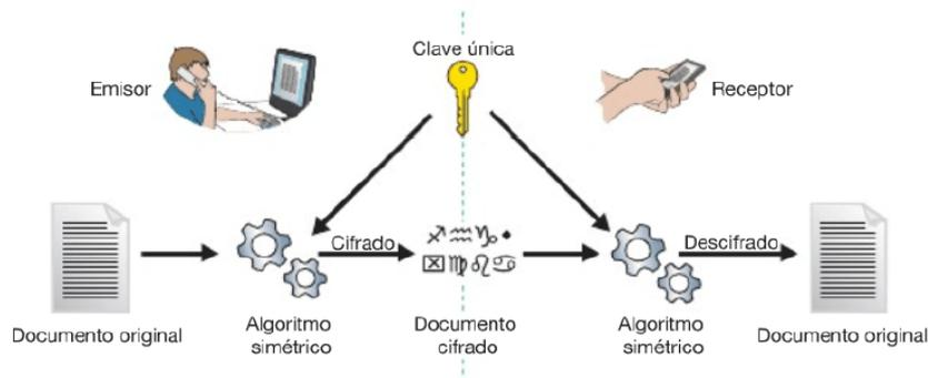
Figura 5: Criptografía de llave simétrica
