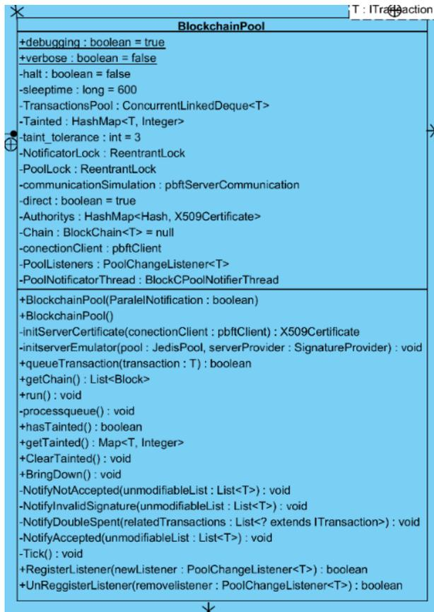
Figura No. 39 Diagrama de clases de la piscina de transacciones
