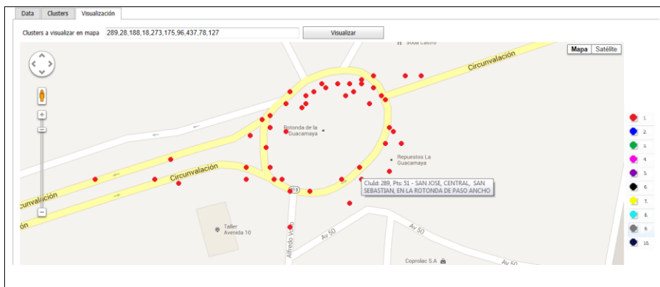
Figura 4.13 Pantalla Visualización, Cluster número 1 (eps = 50 metros) Software para aplicar algoritmo de Agrupamiento. Fuente propia
